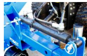
Vérin de déport hydraulique à double effet 300 mm
